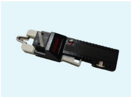
Предназначены для кратковременного измерения напряжения и тока без разрыва токовой цепи в сетях переменного тока. Для этой цели амперметр имеет встроенный трансформатор тока с разъемным магнитопроводом.
